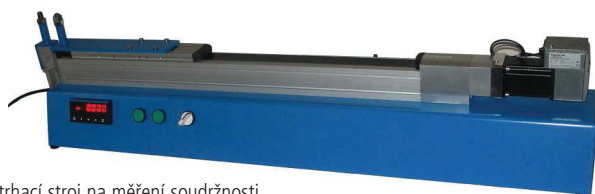
trhací stroj na měření soudržnosti
